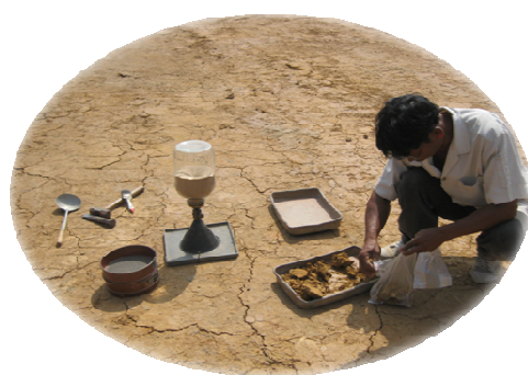
ตรวจสอบความแน่นของดิน
